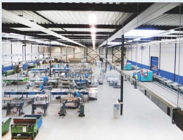
Mensch und Maschine Rechts eine doppelte MABI-Strasse für zwei mal acht Rohrmeter pro Minute, links das Team von Fachspezialisten, die dies äusserst effizient zu montagefertigen Projektpakete verarbeitet.
