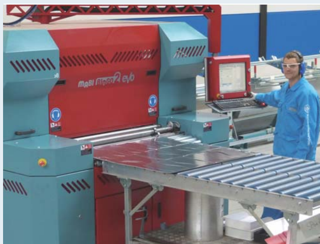
Zum Schneiden von Formstücken verwendet Bilfinger Mabis patentiertes Topmodell Bingo 2 EVO, einen vollautomatischen Alleskönner für Isolierbleche: Doppelles Schneidsystem, automatische Breitereinstellung, Produktcodierung mit schnell trocknender Tinte, Optimierung für die Blechbelegung (Nesting) und Online-Programmierung. Die Maschine kann vollständig bei der Arbeitsvorbereitung programmiert werden. Hierbei können auch die Codiertexte angepasst oder erweitert werden.
