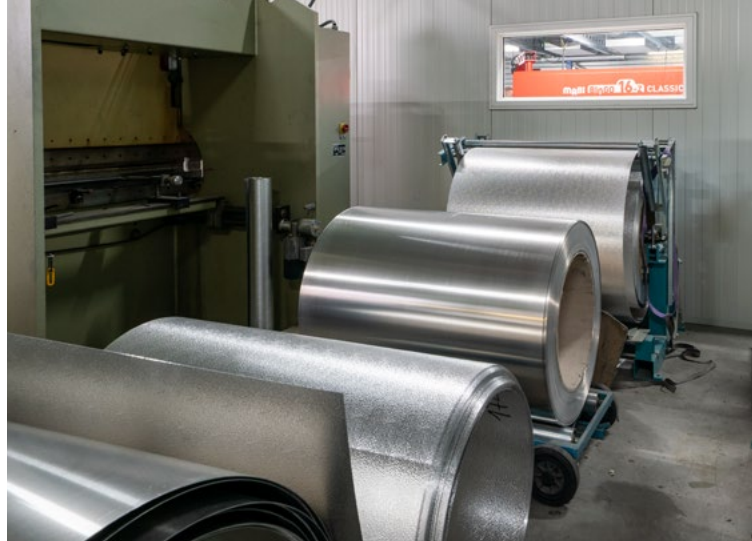
L'alluminio in rotolo viene alimentato alla macchina dall'esterno dello stabilimento.
